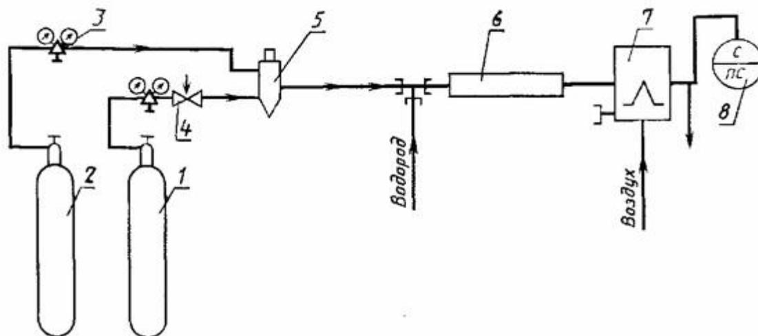
1 - баллон с анализируемым газом; 2 - баллон с газом-носителем; 3 - редуктор баллона; 4 - вентиль тонкой регулировки; 5 - дозатор; 6 - газохроматографическая колонка; 7 - реактор; 8 - детектор пламенно-ионизационный; 9 - измерительный прибор
